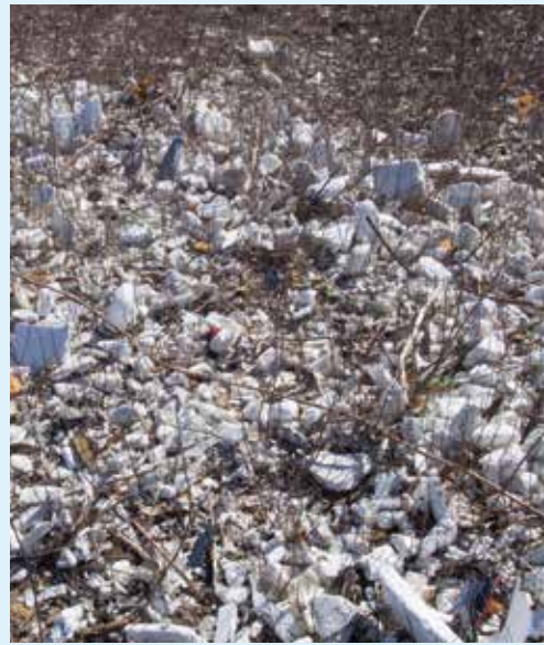
▲風化によりバラバラになった発泡スチロール
